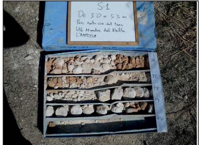
Caixa de testimonis del sondeig S-1 entre 3,0 i 5,5 m.
